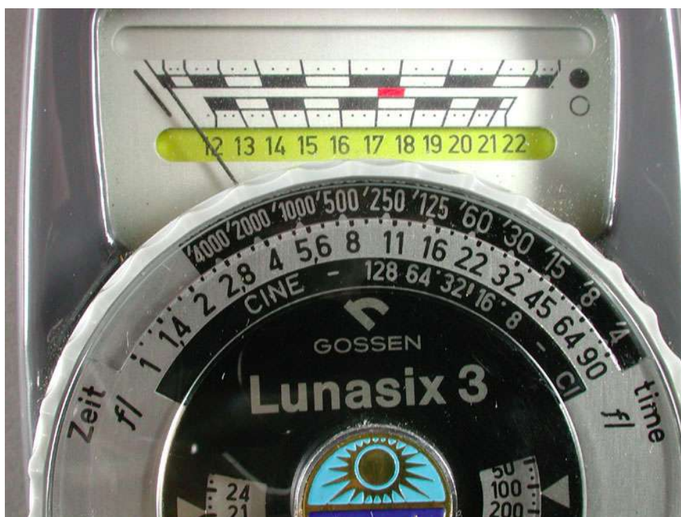
Το όργανο θα δώσει όλους τους συνδυασμούς κλείστρου και ίριδας.
