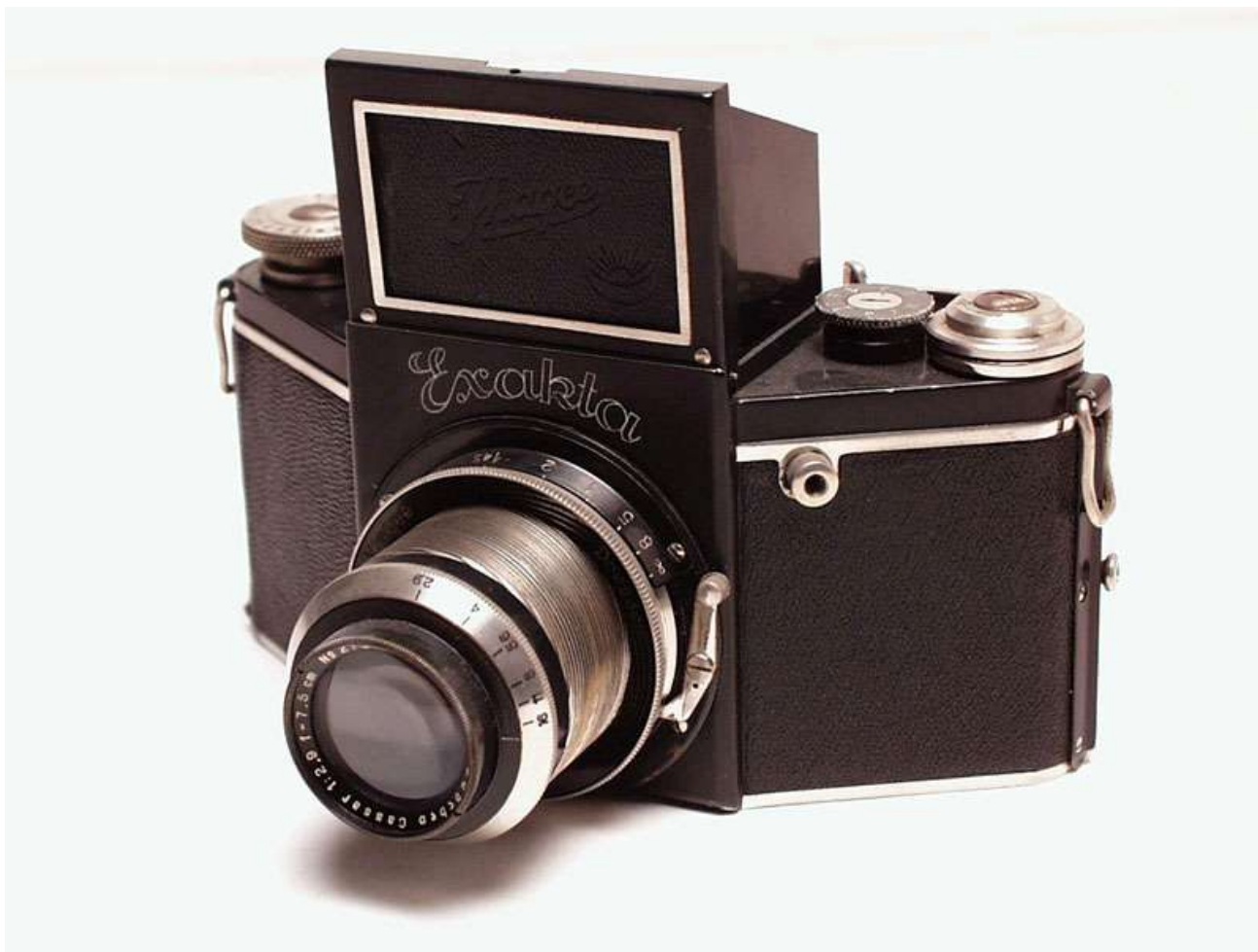
Ατσάλινη συλλεκτική Exakta. Η εστίαση γίνεται με χειροκίνητη περιστροφή του φακού (βίδωμα).
